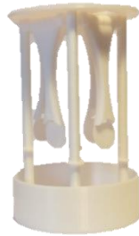
Figura 2.3 Estructura del cansat impresa en PLA. Dimensiones: 110mm x 60mm (diámetro)
