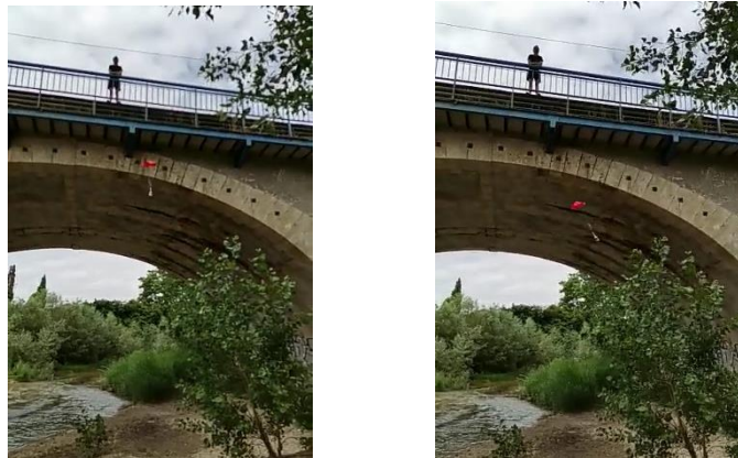
Figura 3.3 Imágenes de algunas de las pruebas realizadas con el paracaídas. En este caso desde una altura de 11,5 m y masas de 340 y 170 g.
