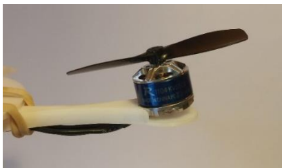
Figura 2.7 Imagen de uno de los soportes para los motores y las hélices que se despliegan mediante un sistema de gomas elásticas durante el vuelo
