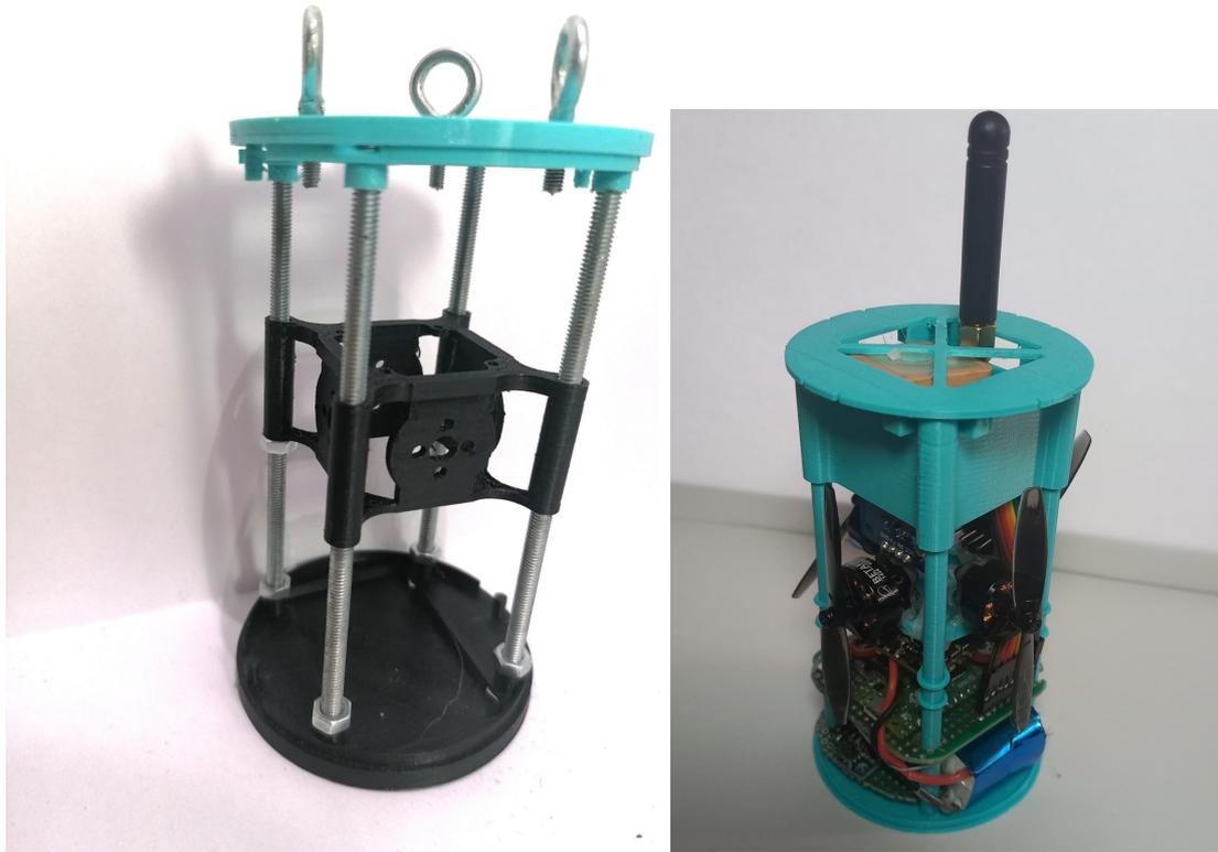
Figura 6: Estructura completa, y prototipo del cansat construido
